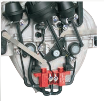
Vanne électrique d'inversion (EUV) (accentuée) sur la tubulure d'aspiration d'une Mercedes-Benz Classe C.
