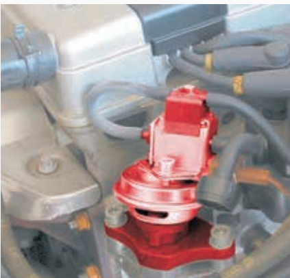
Convertisseur de pression électrique (EDW) sur la vanne EGR d'une Opel Astra (accentuée).
