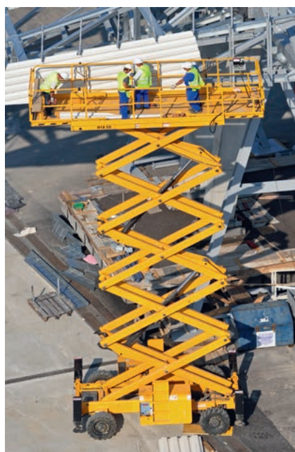
Plateforme de travail avec des articulations à parallélogramme
