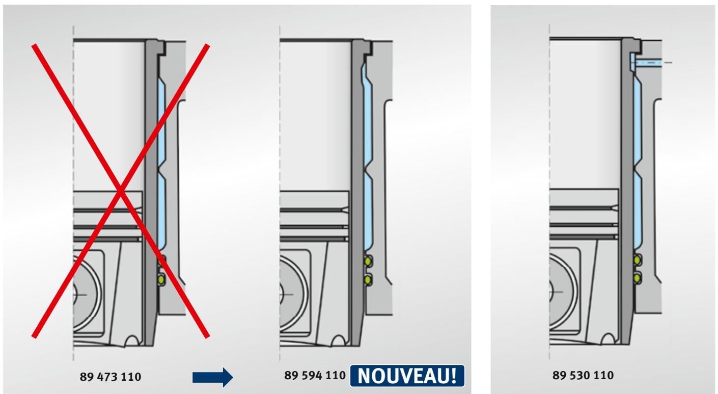
Le constructeur du moteur a apporté des modifications au niveau du type de la chemise de cylindre.
