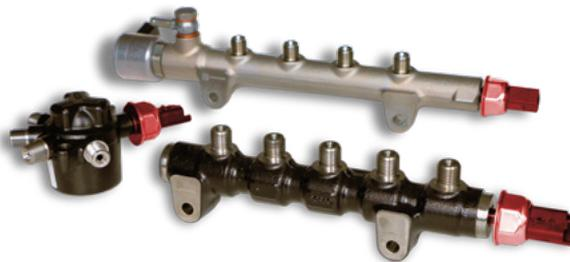
Sensores de presión del combustible en el rail (destacado en rojo)
