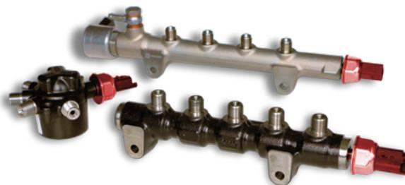
Датчики давления топлива на топливопроводе Rail (выделено красным)
