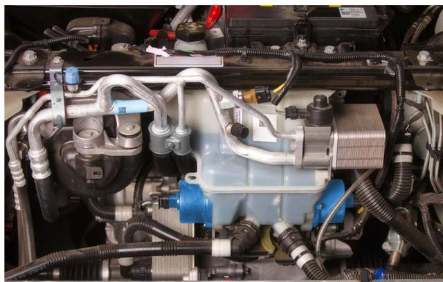
Насосы охлаждающей жидкости (синие) в Tesla Model 3
