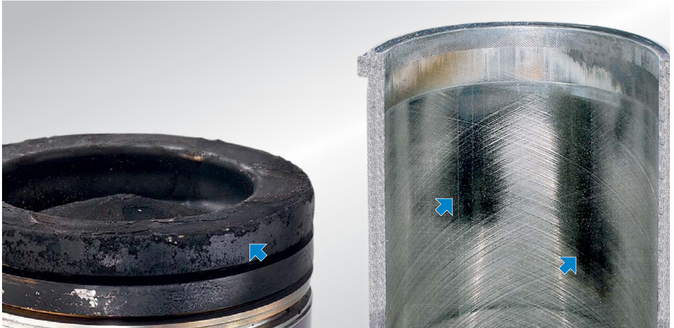
Şekil 4: Pistonun üst kısmında yağ karbon tabakası ve silindir çalışma yüzeyinde aşınma
