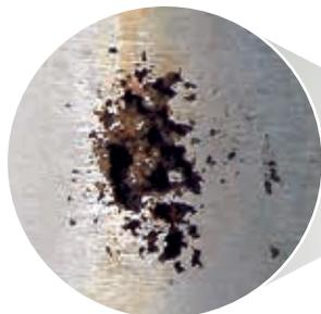
Abb. 1: Kavitationsschäden an der Zylinderlaufbuchse
