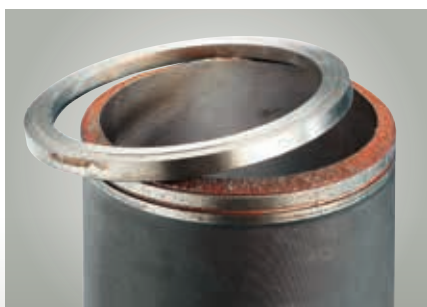
Abb. 1: Abgerissener Bund der Zylinderlauf- buchse
