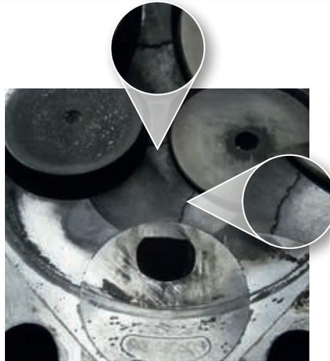
Abb. 1: Spannungsrisse im Zylinderkopf
