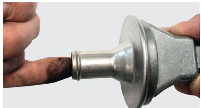
示意图1: 止回阀的简单检验
