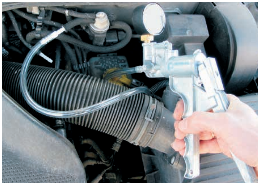
Provera elektropneumatskog pretvarača pritiska pomoću ručne vakuumpumpe (VW Golf IV)
