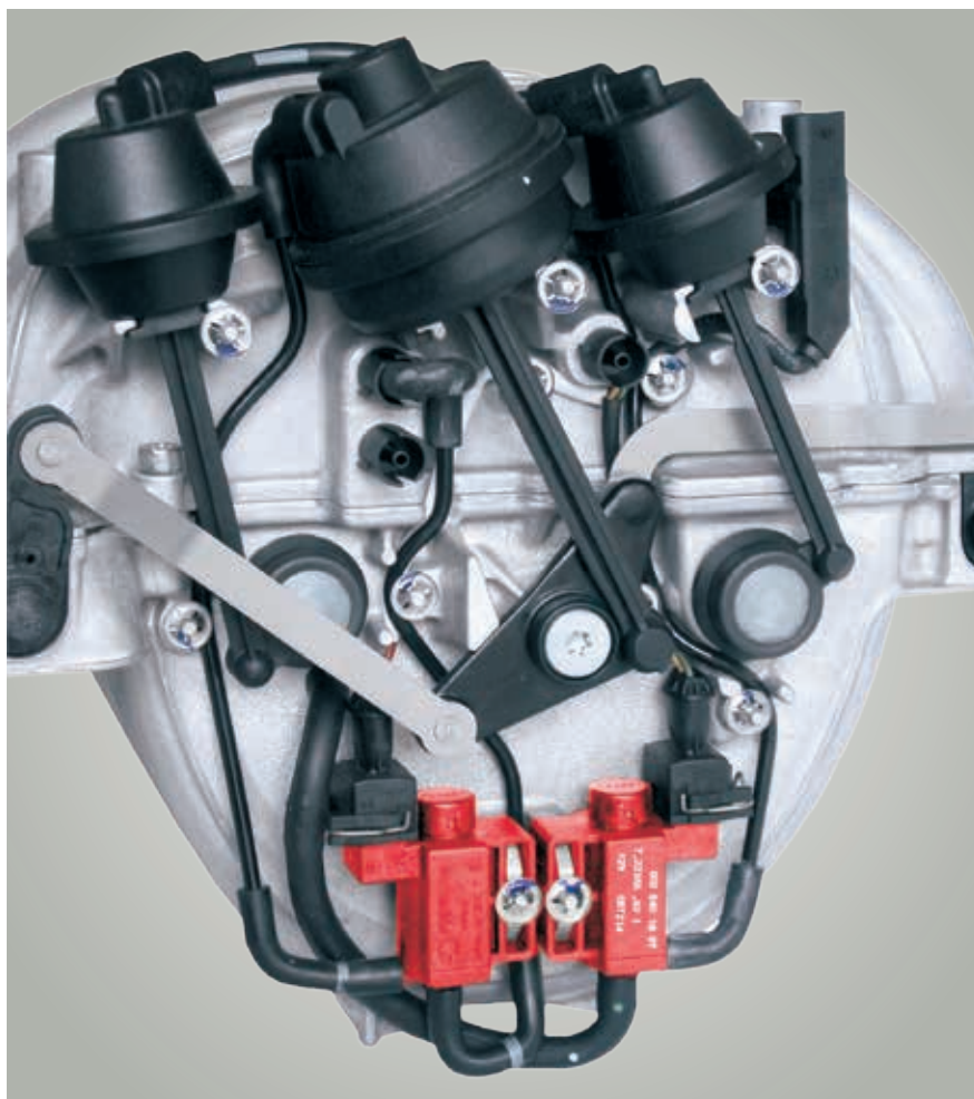
Primer: Usisna grana sa elektropneumatskim ventilima (označeni crveno) u Mercedes-Benz C-klasi.
