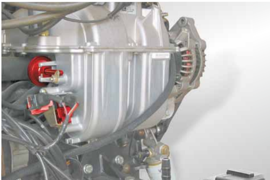
På det omkopplingsbara insugningsröret i Opel Astra sitter två el-omkopplingsventiler (rödmarkerade). En styr med tryckdosan ovanför (rödmarkerad) insugningsrörsspjällen; den andra kopplar om avstängningsventilen för sekundärluft (ej på bild).
