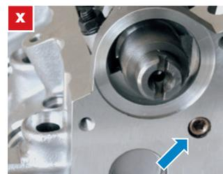
Bei Vakuumpumpen, die über die Nockenwelle angetrieben werden, muss diese Verschlusschraube aus dem Zylinderkopf entfernt werden.
