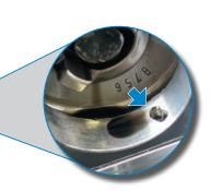
Prestare la massima attenzione alla pulizia! I residui carboniosi e di guarnizione possono causare la chiusura dei fori di lubrificazione.
