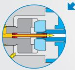
Lubrificazione diretta mediante tubo dell'olio
