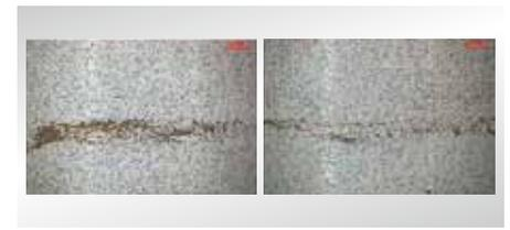
Schaden durch Erosion in der Einlaufschicht P1-Gleitlager
