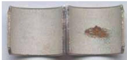
Örtlicher Schaden durch Kavitation
