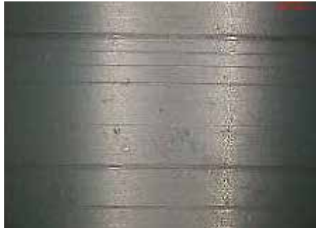
Abb. 1: P2-Gleitlager, Riefen in der Lauffläche
