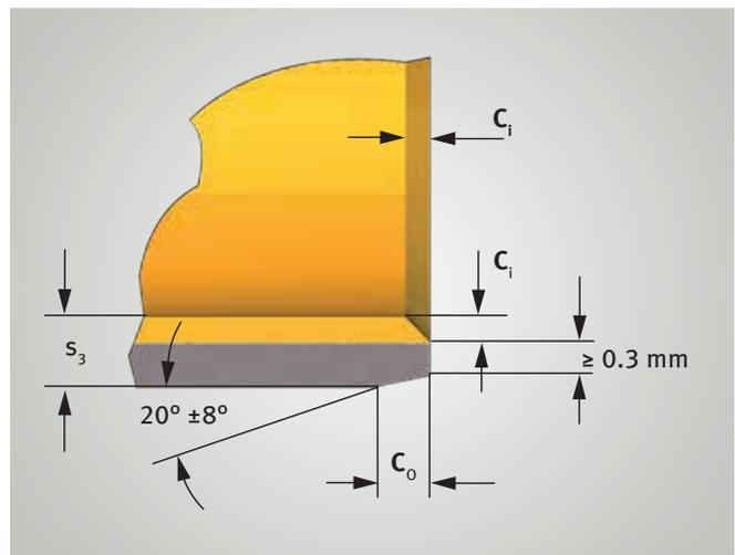
Abb. 2: Außenfase  $C_o$  und Kantenbruch innen  $C_i$  bei metrischen Abmessungen
