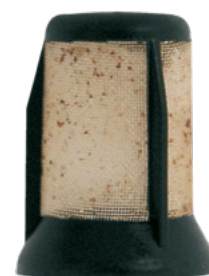
Prefiltro della pompa E3T – intasato dalla ruggine
