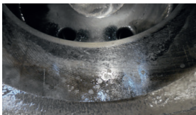
Détériorations de la surface par microfriction sur une boîte de vitesses
