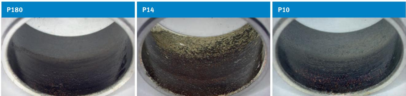
Verschleiß der Gleitschicht bei P180, P14 und P10 Gleitlagern nach dem Test Rotation im Trockenlauf mit Kantenlast
