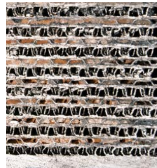
Zatkane lamele chłodzące
