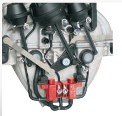
Válvula eléctrica de conmutación (EUV) (destacada) en el tubo de aspiración de un Mercedes-Benz clase C.
