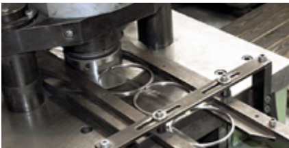
Installation automatique d'alésage interne – Réalisation des contours intérieurs
