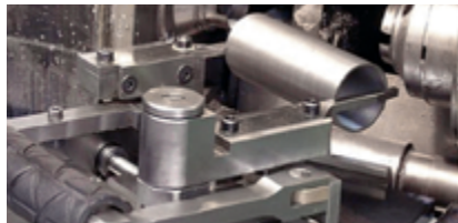
Ponçage des surfaces de contact des segments
