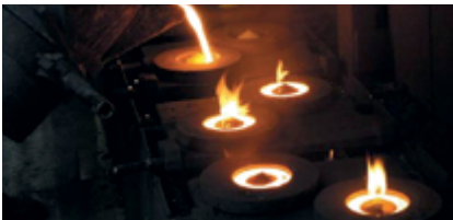
Coulée des segments bruts (coulage en coquilles)
