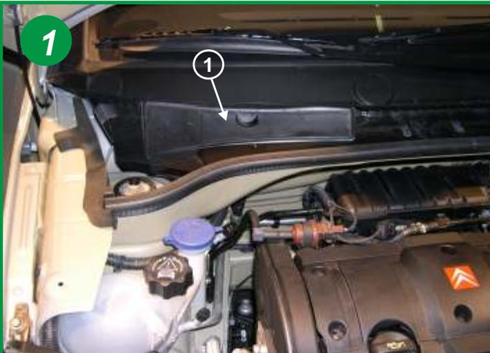
L'élément filtrant est situé sous le capot moteur coté passager. (voir flèche 1)
