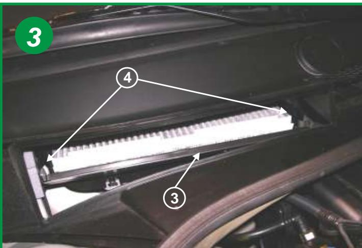
Basculer le couvercle charnière (voir flèche 3) et actionner les deux languettes (flèche 4) afin de dégager l'élément filtrant usagé.
