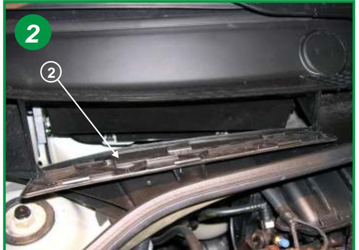
Retirer la trappe d'accès au boîtier de l'élément filtrant (voir flèche 2).
