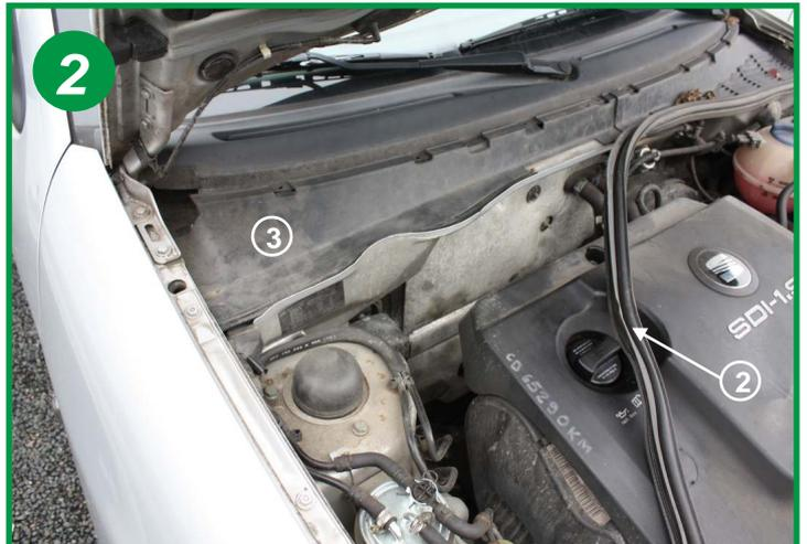
Retirer sur la moitié le joint d'étanchéité du compartiment moteur (2).
