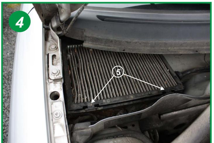
Actionner les 2 pattes de fixation (5) pour retirer le filtre usagé et son cadre, remplacer le filtre et le reloger dans son cadre.
