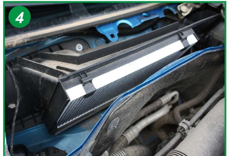
Replacer dans son logement un filtre neuf et basculer les 2 fermoirs. Le remontage s'effectue dans l'ordre inverse du démontage.
