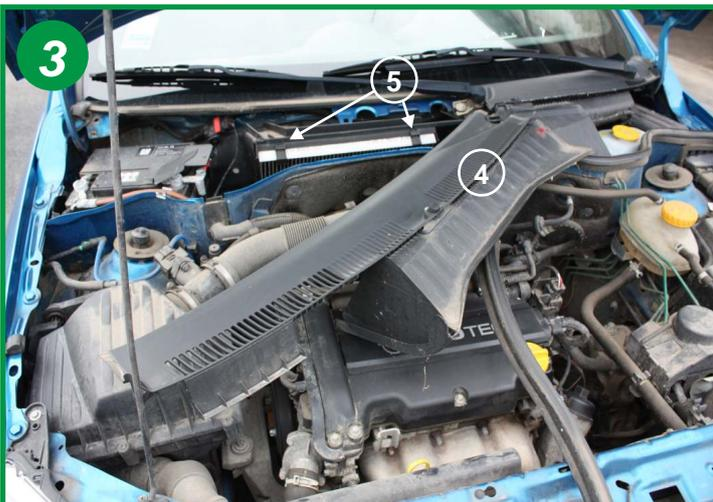
Déboîter et retirer partiellement le carter rigide (4) (ceci pour éviter d'endommager la durite de lave-glace). Basculer vers le haut les 2 fermoirs (5) et extraire le filtre usagé.
