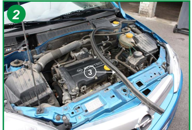
Retirer sur un peu plus de la moitié le joint d'étanchéité du capot moteur (3).
