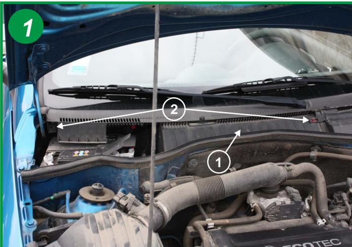
Le filtre d'habitacle est situé sous le capot moteur, au centre devant la baie de pare-brise (1). Dévisser les 2 vis Torx (T25) (2).
