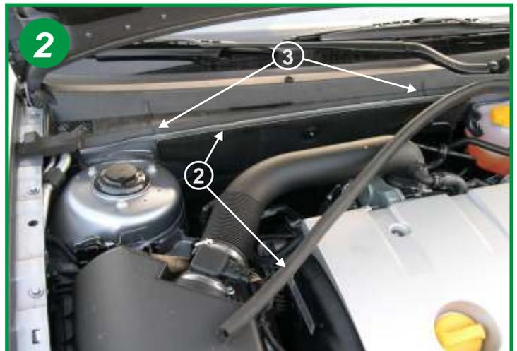
Dégager sur la moitié le joint d'étanchéité du compartiment moteur (flèche 2)
