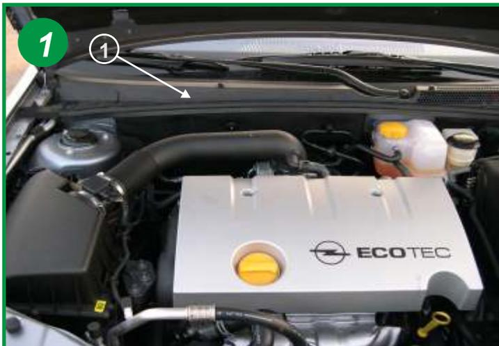
L'élément filtrant est situé sous le capot moteur coté passager devant la baie de pare brise (voir flèche 1). Ouvrir le capot moteur.
