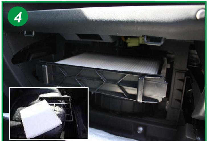
Extraire l'élément filtrant usagé de son cadre et le remplacer (voir encadré). Le remontage s'effectue dans l'ordre inverse du démontage.
