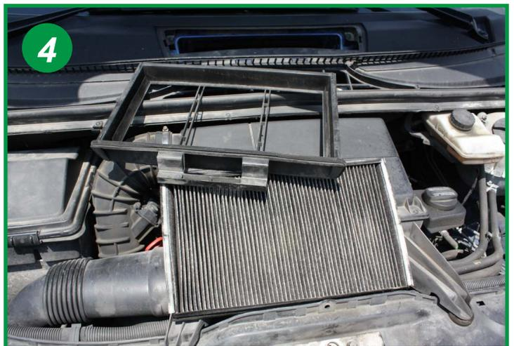
Sortir l'élément filtrant de son cadre et le remplacer.
