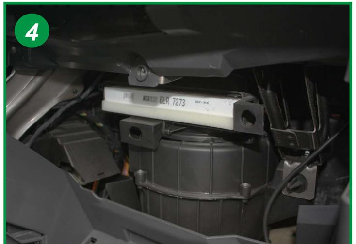
Sortir le filtre usagé et procéder à son remplacement. Le remontage s'effectue dans l'ordre inverse du démontage.
