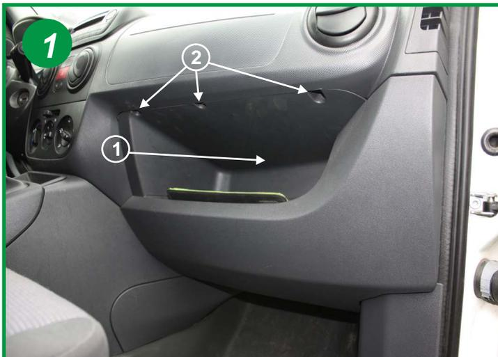
Le filtre d'habitacle est situé à l'intérieur du véhicule, coté passager derrière le vide poche (1). Dévisser les 3 vis Torx (T20) sur la partie supérieure du vide poche (2).
