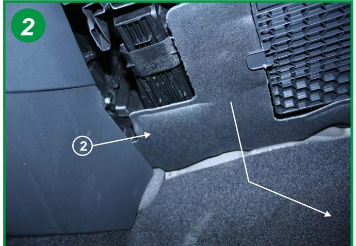
Retirer partiellement le carter souple (2) et le mettre sur le coté.
