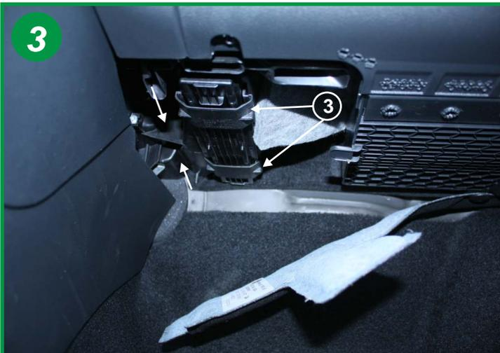
Faire coulisser les 2 bagues (3) dans le sens des flèches pour déverrouiller le couvercle du boîtier filtrant.
