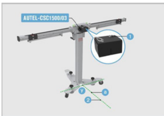
Abbildung 3-22 Installation des Zweilinielasers
