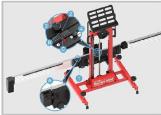
Abbildung 3-3 Positionieren des Kalibrierungsrahmens
