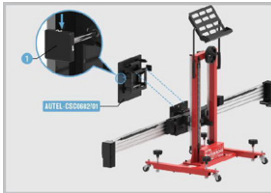
Abbildung 3-17 Anbringen des Reflektors
