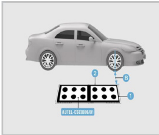
Abbildung 3-52 Positionierung des Musters auf der rechten Fahrzeugseite
