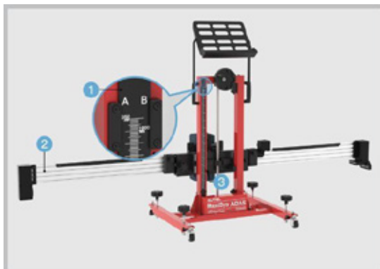
Abbildung 3-31 Einstellen der Höhe der Querstange
