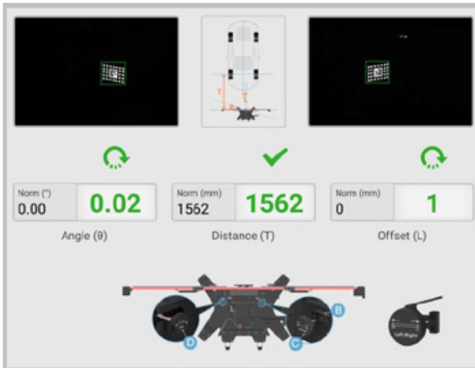
Bild 6-82 Einstellen des Kalibrierungsrahmens
