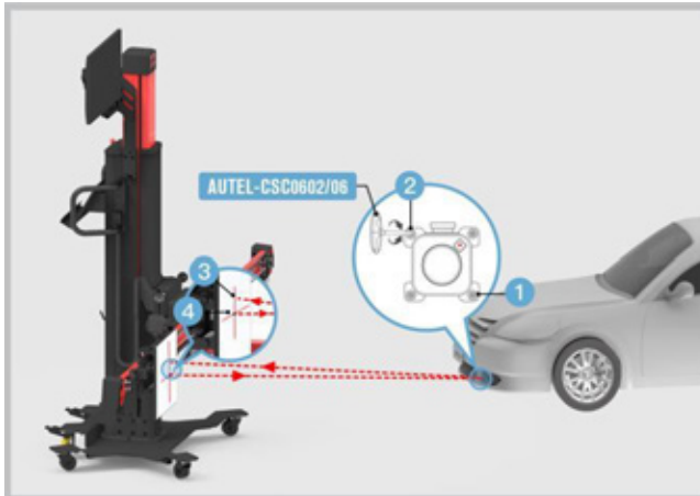
Abbildung 6-11 Ausrichten des Reflektorlasers mit dem Ursprungslaser
