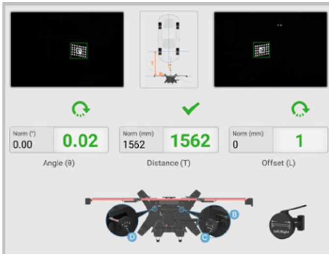
Abbildung 6-97 Positionieren des Kalibrierungsrahmens
