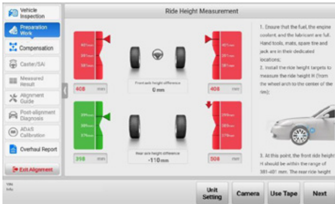
Abbildung 4-33 Messen der Fahrhöhe mit Fahrhöhenziel
