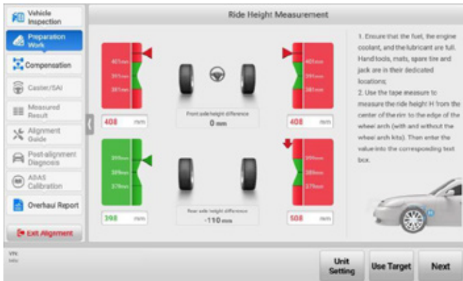
Abbildung 4-30 Messen der Fahrhöhe mit Maßband 1
