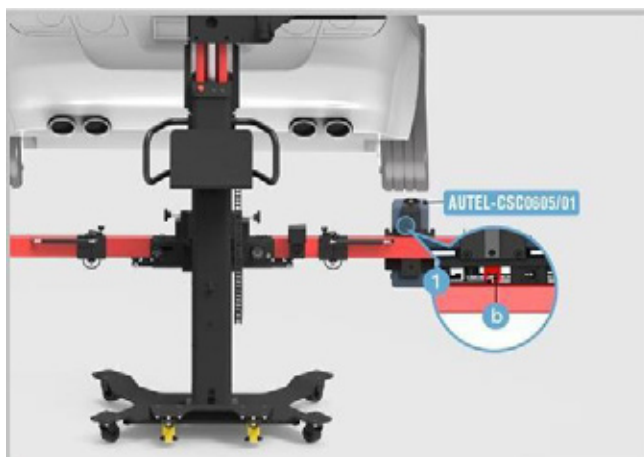
Bild 6-34 Verschieben der Radarkalibrierungsbox (rechts)
