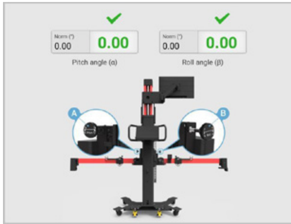
Bild 6-98 Pitch- und Rollwinkel einstellen
