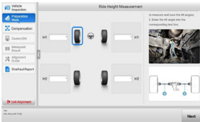
Abbildung 4-34 Messen und Eingeben von Neigungswinkeln
