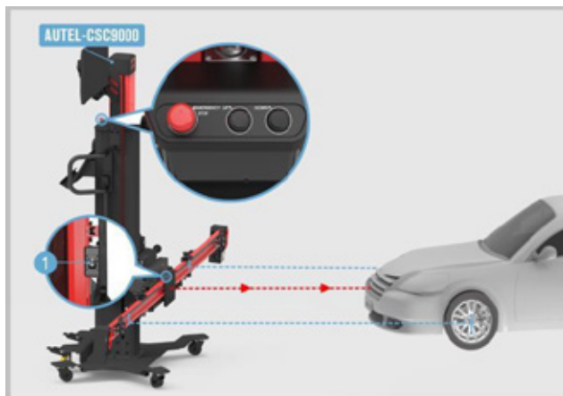
Abbildung 6-91 Zentrieren des Lasers
