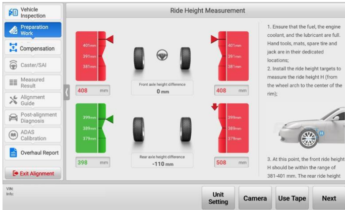
Abbildung 4-33 Messen der Fahrhöhe mit Fahrhöhenziel
