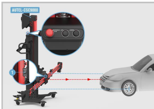
Abbildung 6-4 Zentrieren des Lasers
