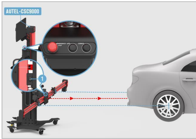
Abbildung 6-38 Zentrieren des Lasers
