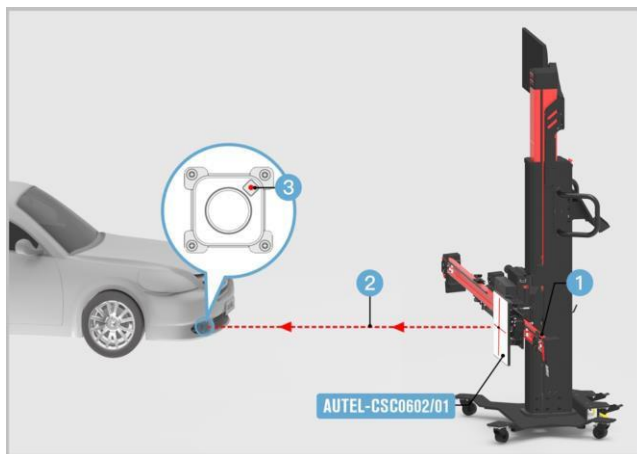
Abbildung 6-16 Ausrichten des Lasers mit dem Mini-Reflektor
