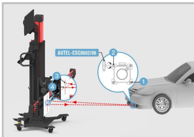
Abbildung 6-11 Ausrichten des Reflektorlasers mit dem Ursprungslaser
