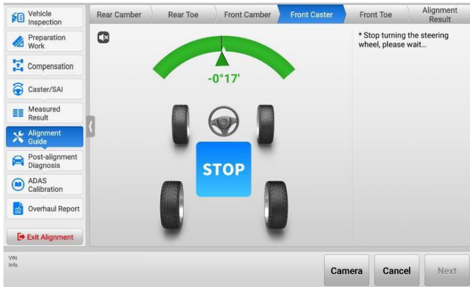
Bild 4-63 Einstellung des Lenkrads
