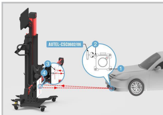
Abbildung 6-11 Ausrichten des Reflektorlasers mit dem Ursprungslaser
