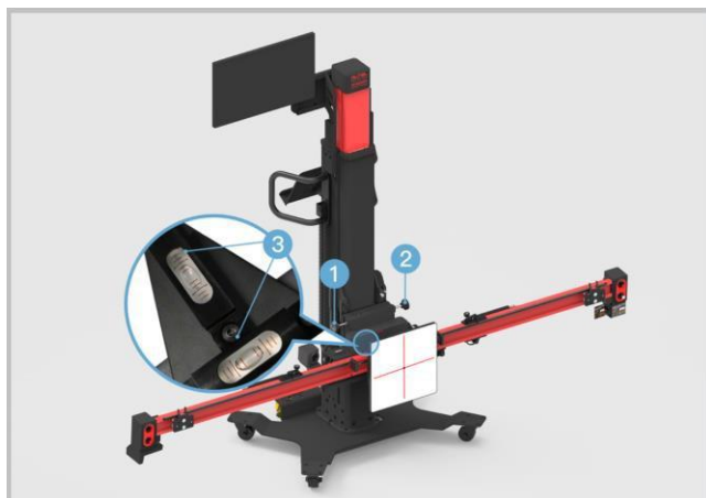
Abbildung 6-9 Einstellen des Reflektors 2
