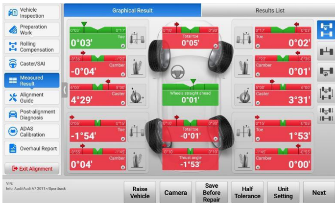
Abbildung 5-66 Bildschirm "Gemessenes Ergebnis (volle Toleranz)"
