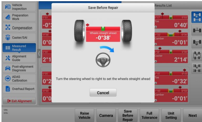
Abbildung 5-63 Speichern vor der Reparatur Bildschirm 1
