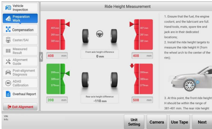
Abbildung 4-33 Messen der Fahrhöhe mit Fahrhöhenziel
