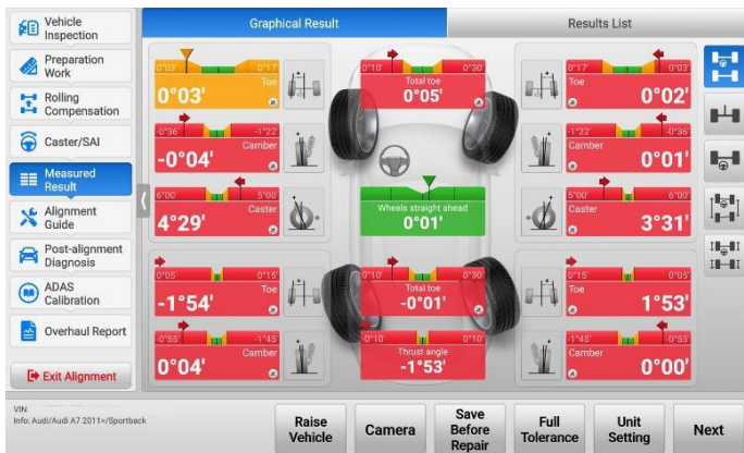
Abbildung 5-65 Bildschirm "Gemessenes Ergebnis (halbe Toleranz)"
