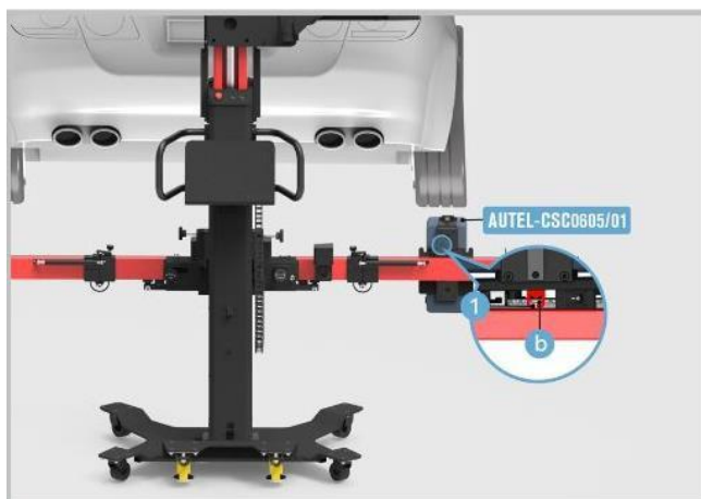
Bild 6-34 Verschieben der Radarkalibrierungsbox (rechts)
