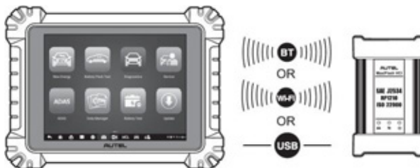
Abbildung 5-4 Anschluss des Tablets an das VCI
