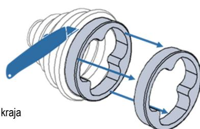
**Savjet za ugradnju:** Nemojte upotrebljavati WD-40 ili sličan proizvod za čišćenje homokinetičkog zgloba jer će ostaviti naslage kad se osuši koje mogu negativno utjecati na novo sredstvo za podmazivanje homokinetičkog zgloba.
