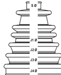
**Monteringstips:** Använd inte WD-40 eller liknande produkter för att rengöra drivknuten eftersom medlet lämnar rester som påverkar det nya fetten negativt när det torkar.
