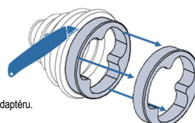
**Tip pro montáž:** K čištění CV spoje nepoužívejte WD-40 ani podobné produkty, protože by po uschnutí zanechaly zbytky, které by měly negativní vliv na nové CV mazivo.
