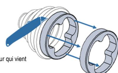
**Conseil d'installation :** N'utilisez pas de WD-40 ou un produit analogue pour nettoyer le cardan au risque de produire un résidu qui, une fois sec, risque de compromettre la nouvelle graisse.
