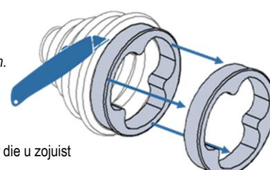
**Installatietip:** Gebruik geen WD-40 of vergelijkbaar product om de homokinetische koppeling te reinigen. Dit laat resten achter die opdrogen en dan een negatieve uitwerking kunnen hebben op het nieuwe koppelingsvet.
