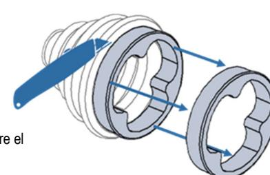
**Consejo de instalación:** No utilizar WD-40 ni un producto similar para limpiar la junta homocinética, ya que al secar deja un residuo que tiene efectos negativos para la grasa de la nueva junta homocinética.
