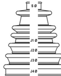
**Savet za postavljanje:** Nemojte koristiti WD-40 ili sličan proizvod za čišćenje homokinetičkog zglova zato što će se nakon sušenja pojavit ostaci koji mogu negativno da utiču na novu mast za zglob.
