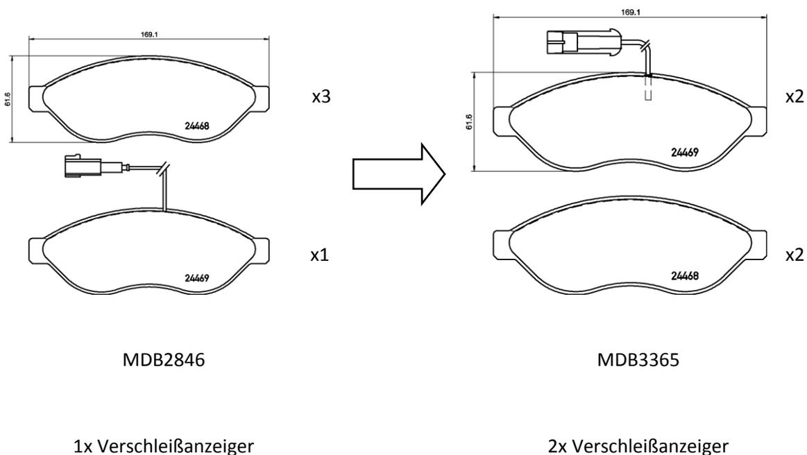
Noch existierender Bestand von MDB2846 kann verkauft werden. Bitte achten Sie während der Montage darauf, dass nur Fahrzeuge mit einem Verschleißanzeiger den Artikel MDB2846 nutzen können.
