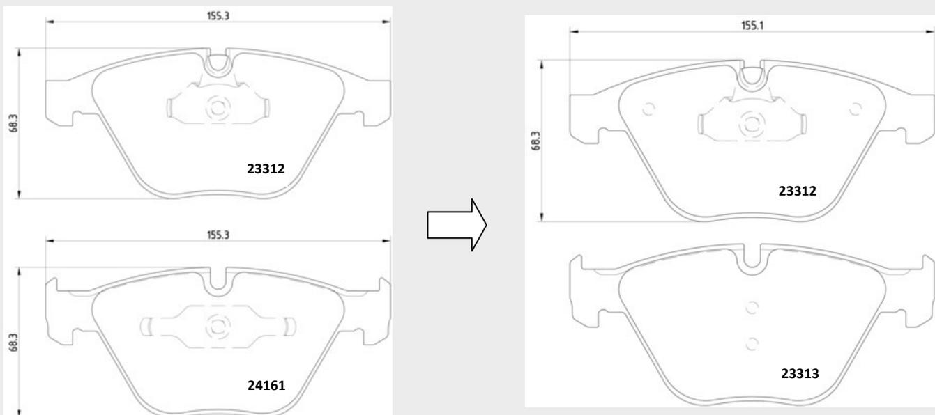
MDB3133 ist rückwirkend für alle Fahrzeuge einsetzbar. Der Unterschied besteht in der faustseitigen Feder, die nun mit MDB3133 für alle Fahrzeuge entfernt wurde.
