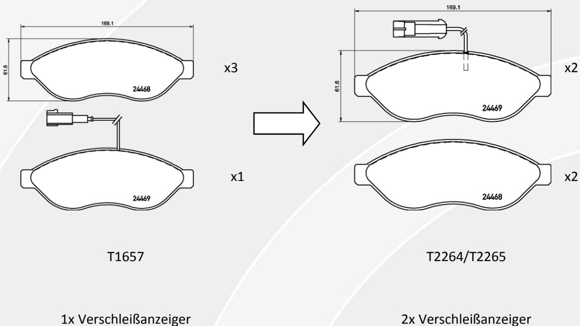
Noch existierender Bestand von T1657 kann verkauft werden. Bitte beachten Sie für den Einbau, dass nur Fahrzeuge mit einem Verschleißanzeiger T1657 nutzen können.
