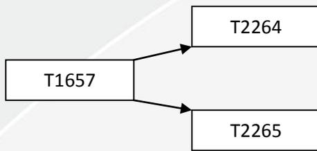
Die "neuen" Teilenummern enthalten Zubehör, welches für den Einbau benötigt wird. Aufgrund verschiedener Zuladungen der verknüpften Fahrzeuge gibt es unterschiedliche Zubehöre und daher auch unterschiedliche Teilenummern. Deshalb wird T1657 auf diese zwei Nummern aufgeteilt
