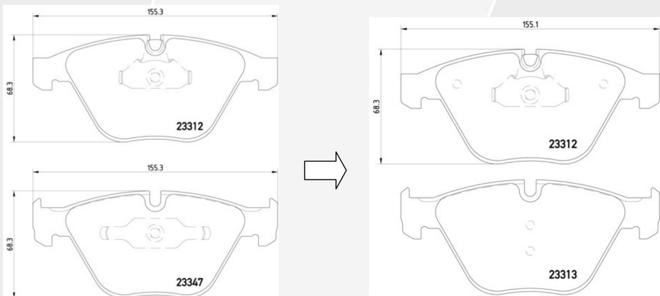
2331211 ist rückwirkend für alle Fahrzeuge einsetzbar. Der Unterschied besteht in der faustseitigen Feder, die nun mit 2331211 für alle Fahrzeuge entfernt wurde.
