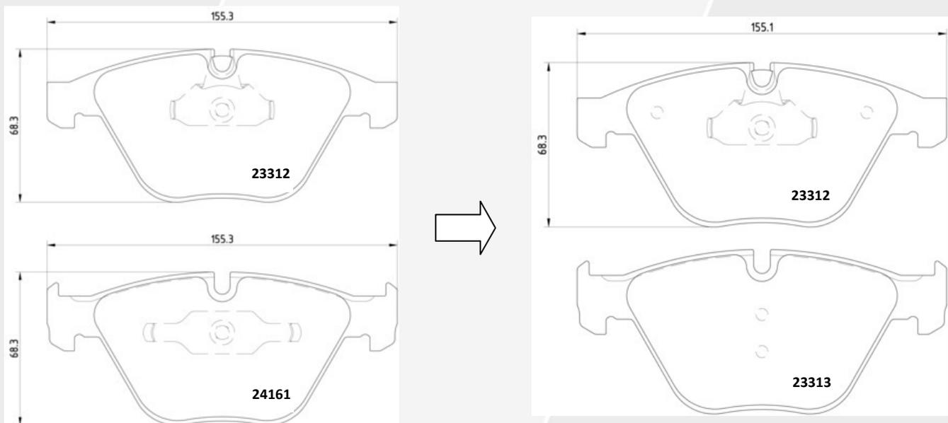
2331303 ist rückwirkend für alle Fahrzeuge einsetzbar. Der Unterschied besteht in der faustseitigen Feder, die nun mit 2331303 für alle Fahrzeuge entfernt wurde.
