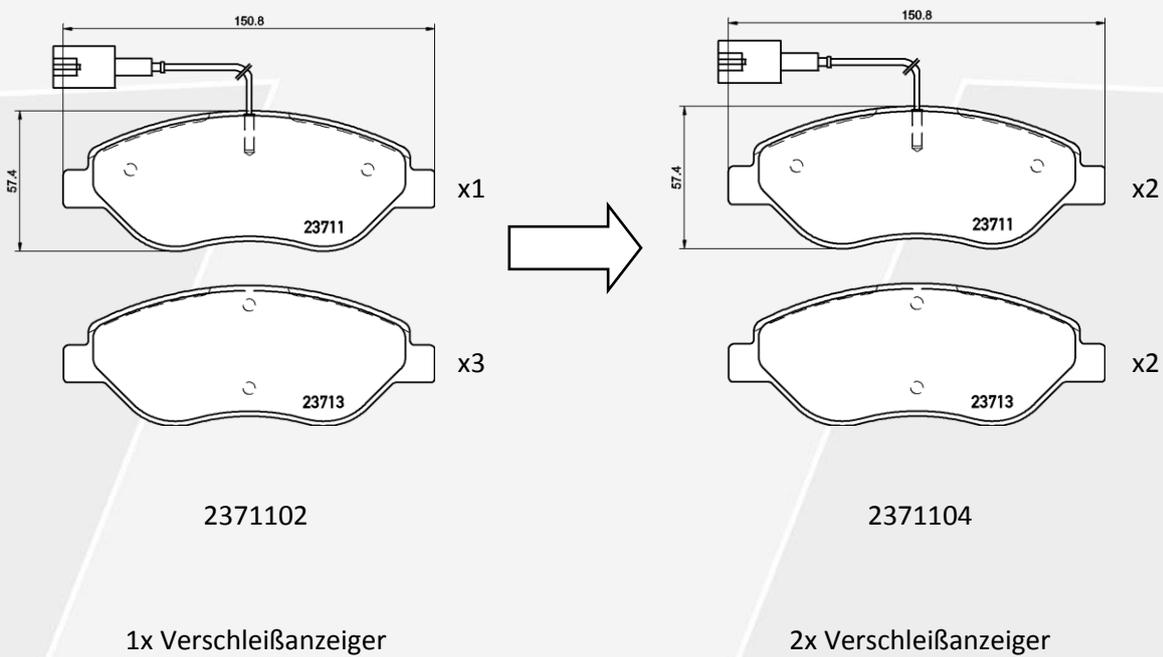
Noch existierender Bestand kann verkauft werden. Bitte achten Sie während der Montage darauf, dass nur Fahrzeuge mit einem Verschleißanzeiger 2371102 nutzen können.
