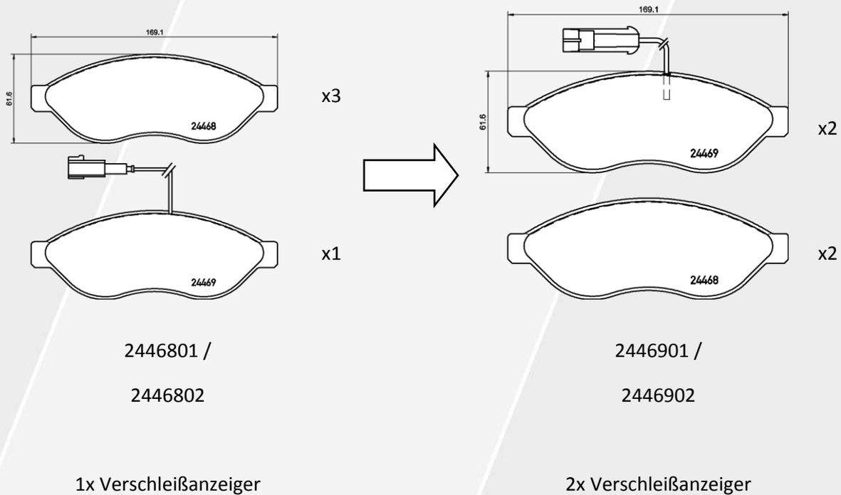
Noch existierender Bestand kann verkauft werden. Bitte achten Sie während der Montage darauf, dass nur Fahrzeuge mit einem Verschleißanzeiger die Artikel 2446801/2446802 nutzen können.
