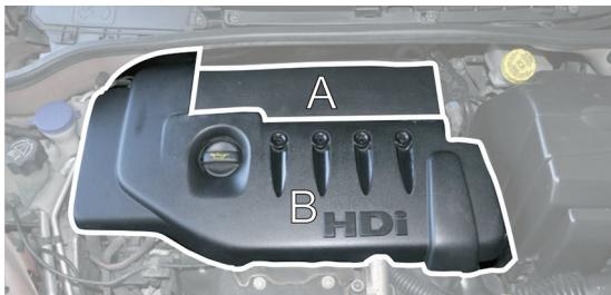
(FR) Démonter le bloc du filtre à air (A), démonter le cache moteur (B)
